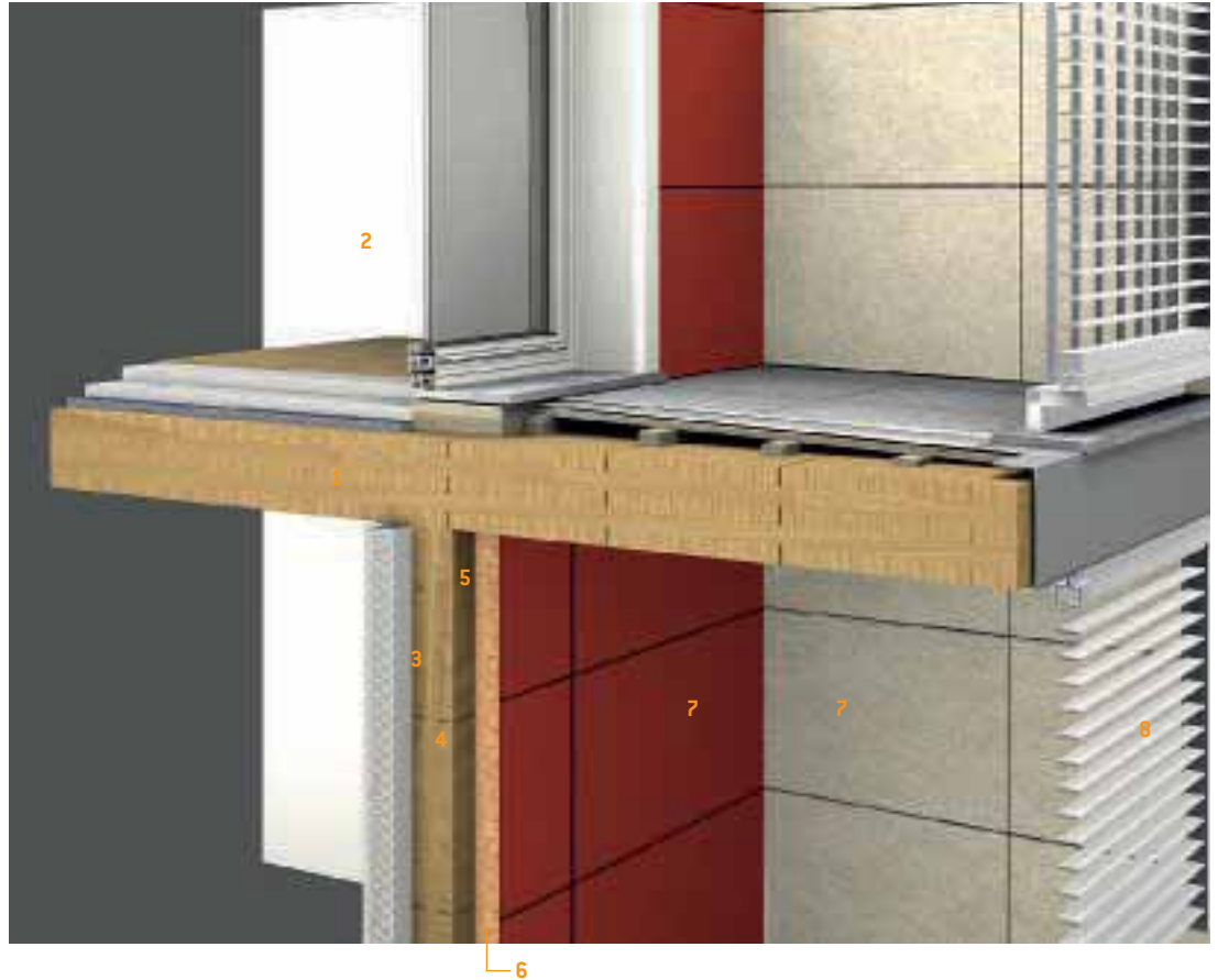
Dettaglio dell'attacco parete-solaio
